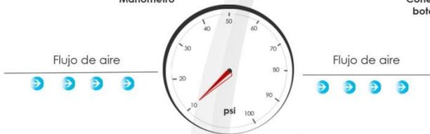
Verifica que el manómetro externo indique la presión de flujo de 10 psi.
